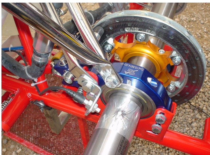
カートへの車速 センサ取付け例
